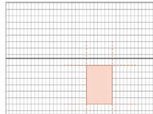
S'intégrer dans le plan de toiture en respectant le calepinage du matériau (vue de haut)
