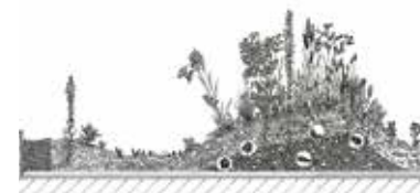
Coupe transversale d'un toit végétalisé, conçu pour valoriser la flore et la faune sauvages. Notez les nombreux types de profondeurs de substrats utilisés.
