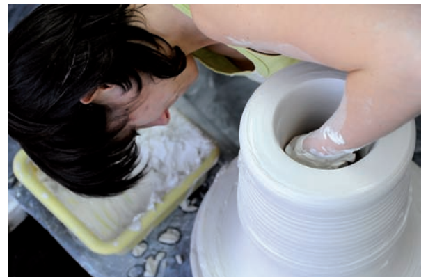
La pièce est creusée à la main par le haut.
